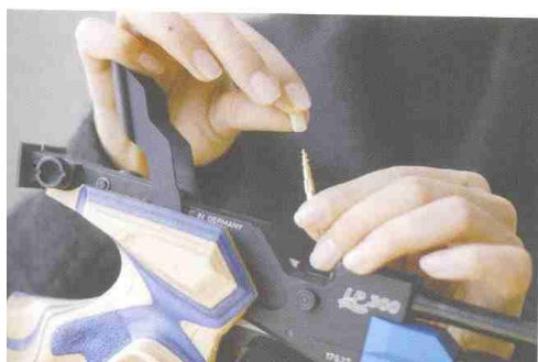
Cuanto más fuerte se atornilla el tapón de fieltro limpiador, tanto mayor es la resistencia al pasar.
